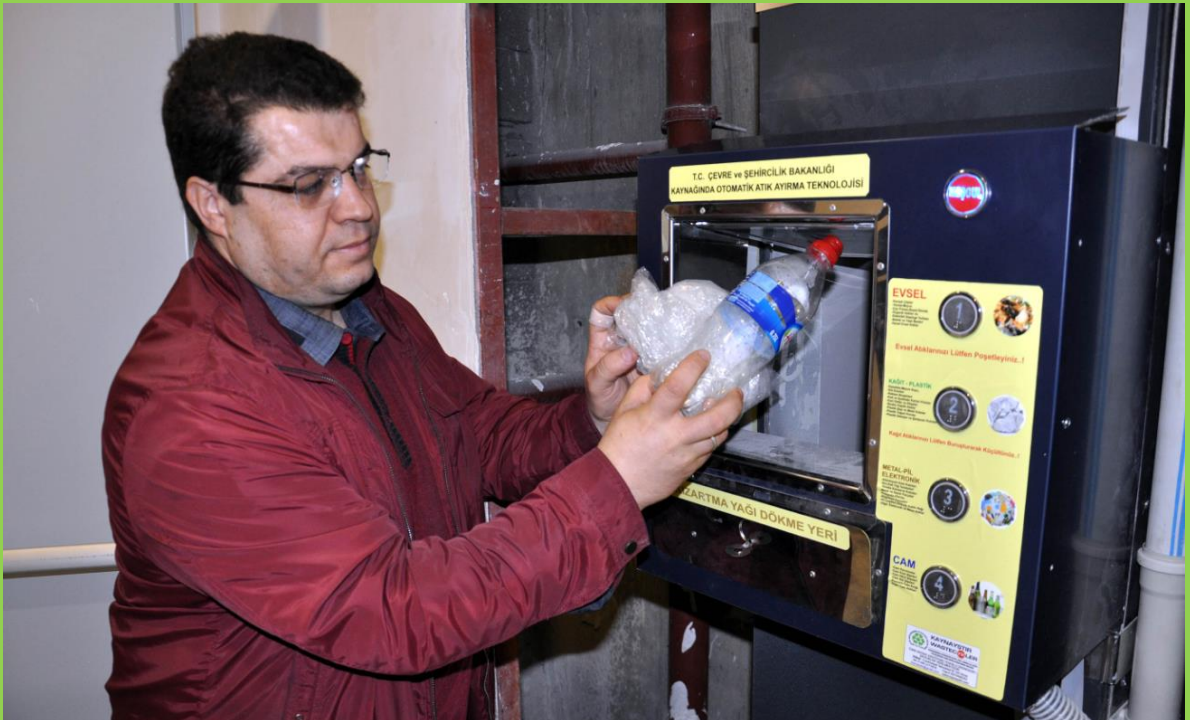
Plastik atık atılırken kapak geçici olarak açılır ve kapanır.
