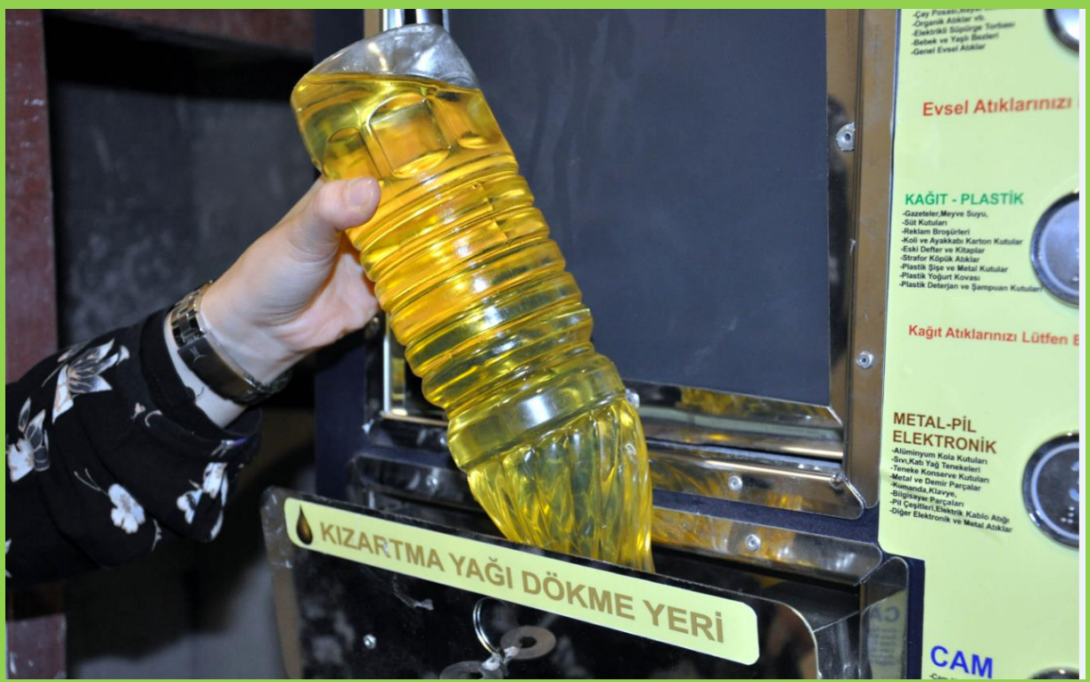
Kızartma yağı çekmecesi özel olarak atık kızartma yağlarını merkezi depoya iletir. Yağdanlık süzgeçleri kolaylıkla çıkarılıp -yıkayıp -yerleştirilmektedir.
